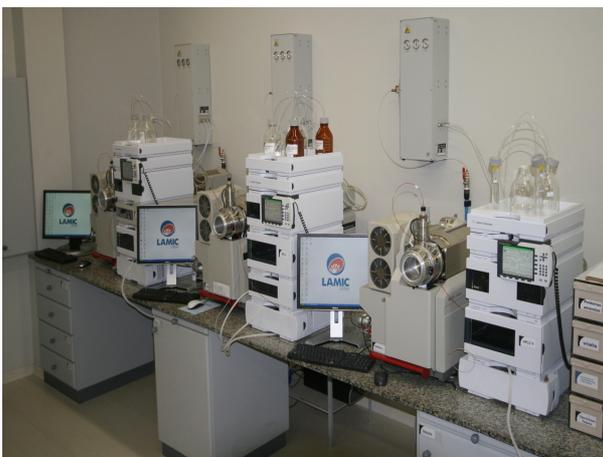
**Figura 11 – Sistema de cromatografia líquida de alta eficiência acoplada a espectrometria de massas seqüencial.**
